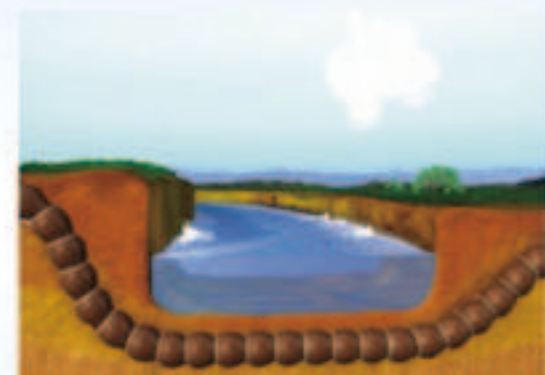
▲景美溪埤渠，用破底大水和聯結成涵管埋入渠底，輸送水源
